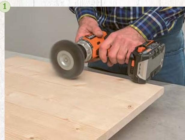
1. Para crear el diseño de dos tonos en las mesas, texturice el panel alistonado con un taladro y un accesorio de cepillo de alambre. Deslice suavemente el cepillo de alambre sobre la superficie de madera en la misma dirección que el grano de madera. Así, se elimina la madera temprana más blanda y de color más claro, mientras la madera tardía, más dura y oscura, permanece. La textura de la madera ahora se destaca notablemente.
