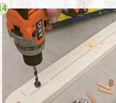
**14.** Use una broca de 6 mm para hacer al menos tres agujeros distribuidos sobre la longitud total del contorno y dentro de la longitud de la espiga. Consejo: Un tope de profundidad en la broca asegura la misma profundidad en los agujeros. Como alternativa, se puede enrollar cinta adhesiva alrededor de la broca.
