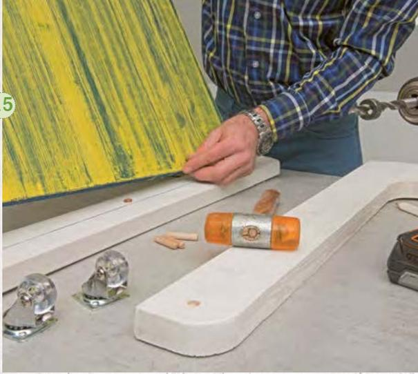
15. Para marcar los agujeros de taladro en el canto del sobre, coloque la plantilla de espiga en los agujeros, alinee el tablero con el contorno trazado y presione hacia abajo. Retire el tablero y haga los agujeros para el taladro. Después de perforar todos los agujeros, pegue las espigas en los costados y coloque los sobres entre los costados. Fije todo con gatos mientras se seca la cola.
