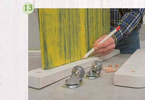
**13.** Las clavijas se usan para fijar los sobres a los lados de la mesa. Para colocarlos, trace el contorno de la mesa en los lados internos de los co-stados de la mesa. La distancia a los extremos es la misma en ambos lados, y el borde superior de los costados debe estar al menos 1 cm sobre el borde superior de los sobres.
