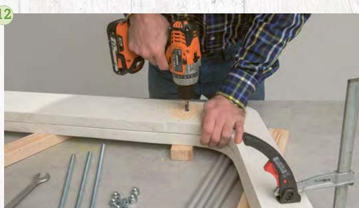
**12.** Para asegurarse de que los orificios de las varillas roscadas estén alineados, coloque ambos costados de la mesa exactamente uno sobre el otro, fíjelos con gatos y luego perforo los orificios. Para evitar que su banco de trabajo sea perforado, coloque un bloque de madera debajo de los costados de la mesa.
