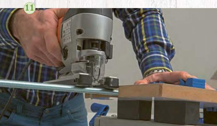
**11.** Las varillas roscadas le dan a los costados de la mesa más estabilidad. Fíjelos en el tornillo de banco o en las mordazas de su banco de trabajo y acórtelos a la longitud adecuada. Corte los cuatro tubos de aluminio a una longitud de 50 cm; Estos se utilizan como cubiertas para las varillas roscadas.
